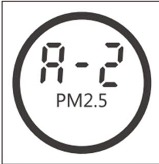
Cuando los filtros estén casi caducados, las luces indicadoras de reemplazo de filtro **A-2** se iluminarán en la pantalla para indicar que los filtros deben ser reemplazados. Si usted no reemplaza los filtros cuando debe:
