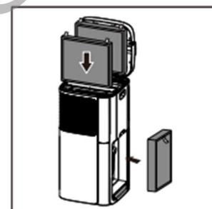
4. Después de que los pre-filtros estén correctamente puestos de nuevo en el dispositivo, resetee el contador de vida del filtro. (Consulte el capítulo 7 “Resetear contador de vida de filtro”).
