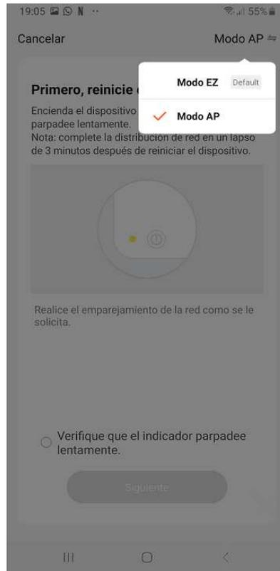
Seleccione arriba a la izquierda el modo AP. Encienda el purificador. Una vez en marcha, pulse la tecla encendido unos 5 segundos hasta que oiga bip. Aparecerá en la pantalla del purificador un icono de señal wifi parpadeando rápido, vuelva a pulsar unos 2 o 3 segundos y hasta que vuelva a hacer bip y el mismo icono parpadeará lento. Pulse en verificar parpadeo lento y siguiete. Pulse conectar en la app.
