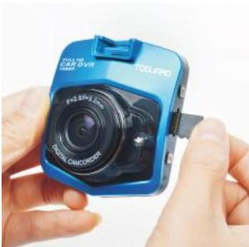
Conecte el dispositivo con su alimentador en el automóvil, cuando encienda el automóvil, el dispositivo se encenderá y se pondrá a grabar, puede apagar y encender la grabación con la tecla OK (2) y bloquear un video manualmente con la tecla LOCK (7), cuando apague el coche el dispositivo se apagará y cerrará los videos pendientes.
