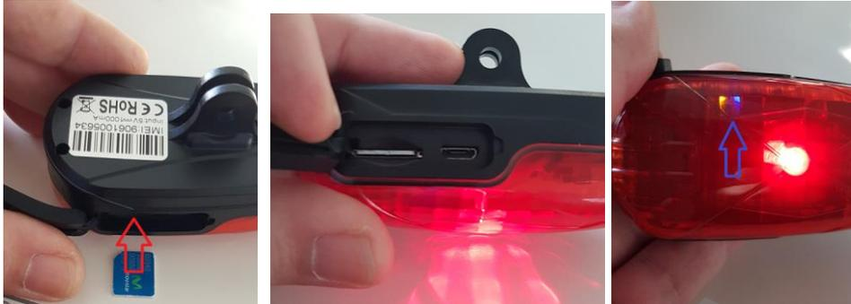
2. Coloque la tarjeta SIM en el dispositivo, en el sentido de la imagen y presione hasta que haga clic y se fije, tiene que entrar hasta que se fije, empuje con la uña o algún utensilio, en ese momento el tracker se encenderá y podrá ver la luz roja.
