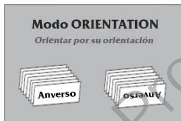
En el modo Orientation, se muestra ORIENT en la LCD y la máquina ordenará los billetes por su orientación al ser transportados.
