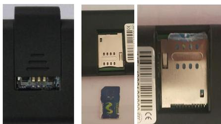
2. Coloque la tarjeta SIM en el dispositivo, en el sentido de la imagen y presione hasta que haga clic y se fije, en ese momento el tracker se encenderá.
